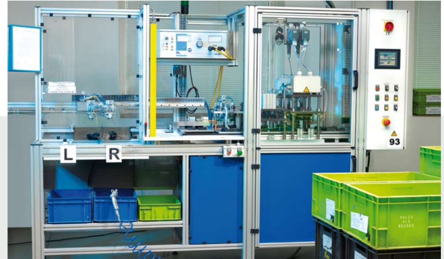
Technologische Spezialausrüstung mit Lineartransport
