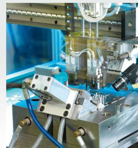
Bestückung des Spritzgießwerkzeuges mit Pins
