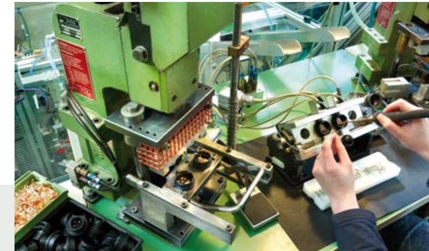
Montagearbeitsplatz zur Herstellung von Waschpumpen für Wischeranlagen
