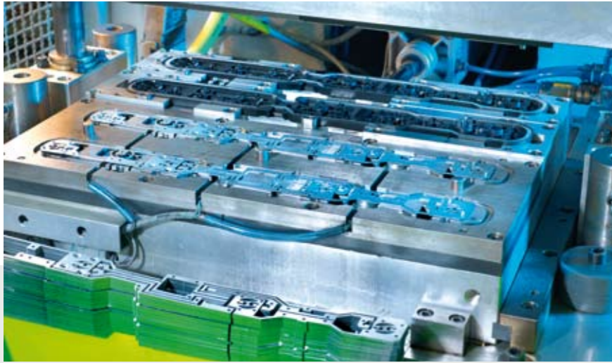
Stanzgitter und Kunststoffteil im Verbundwerkzeug vor dem Umformprozess
