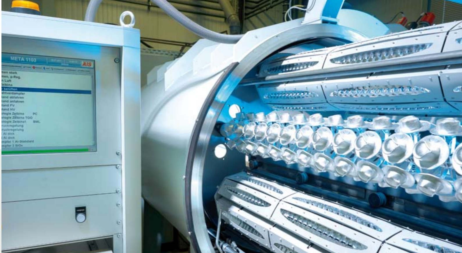
Metallisierungsanlage mit ausgezogenem Trägerkorb
